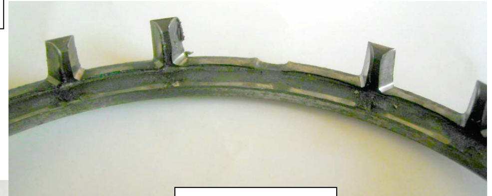
保持器の摩耗や欠損部
