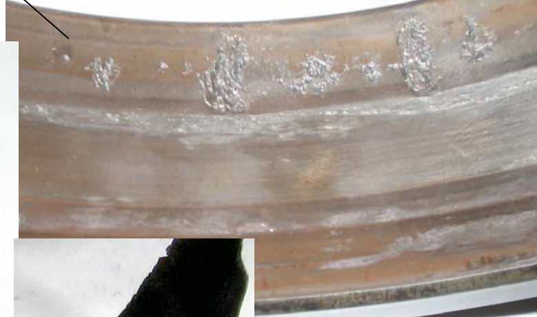
保持器の欠損部がコロに圧迫されて板状に！
