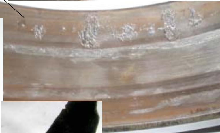
保持器の欠損部がコロに 圧迫されて板状に！
