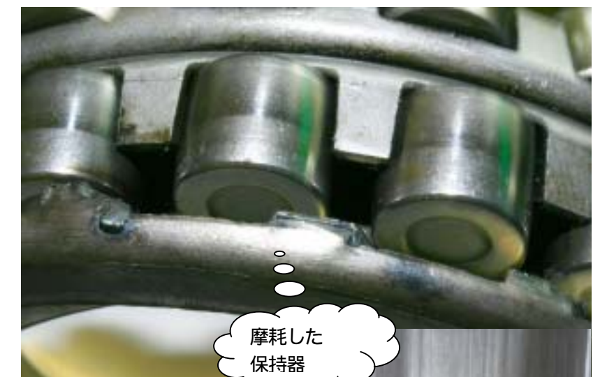
04 部位のベアリングと 03 部位摩耗の保持器
