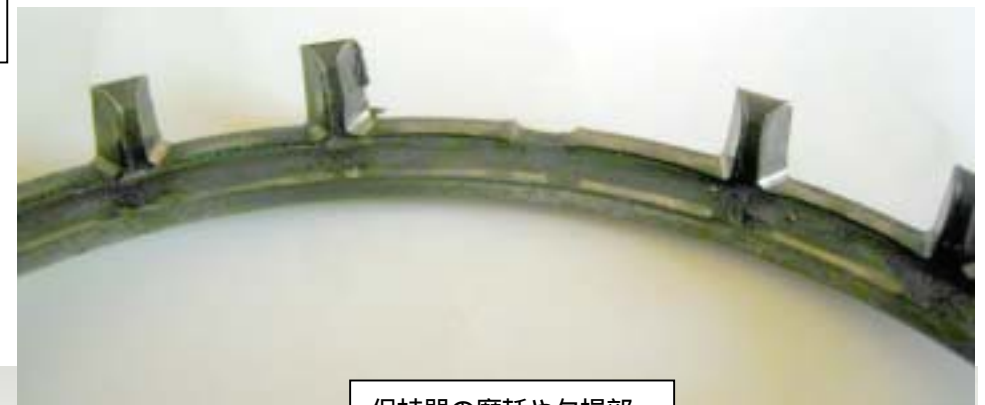
保持器の摩耗や欠損部
